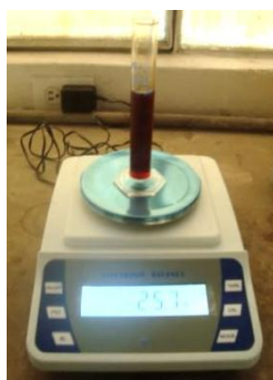
FIGURA 9. Balanza analítica con precisión 0.5g
