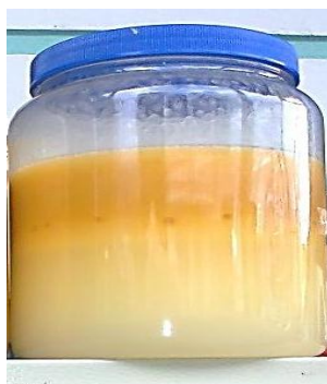
FIGURA 23. Muestra del metiléster en reposo después del lavado (2012-01-18)
