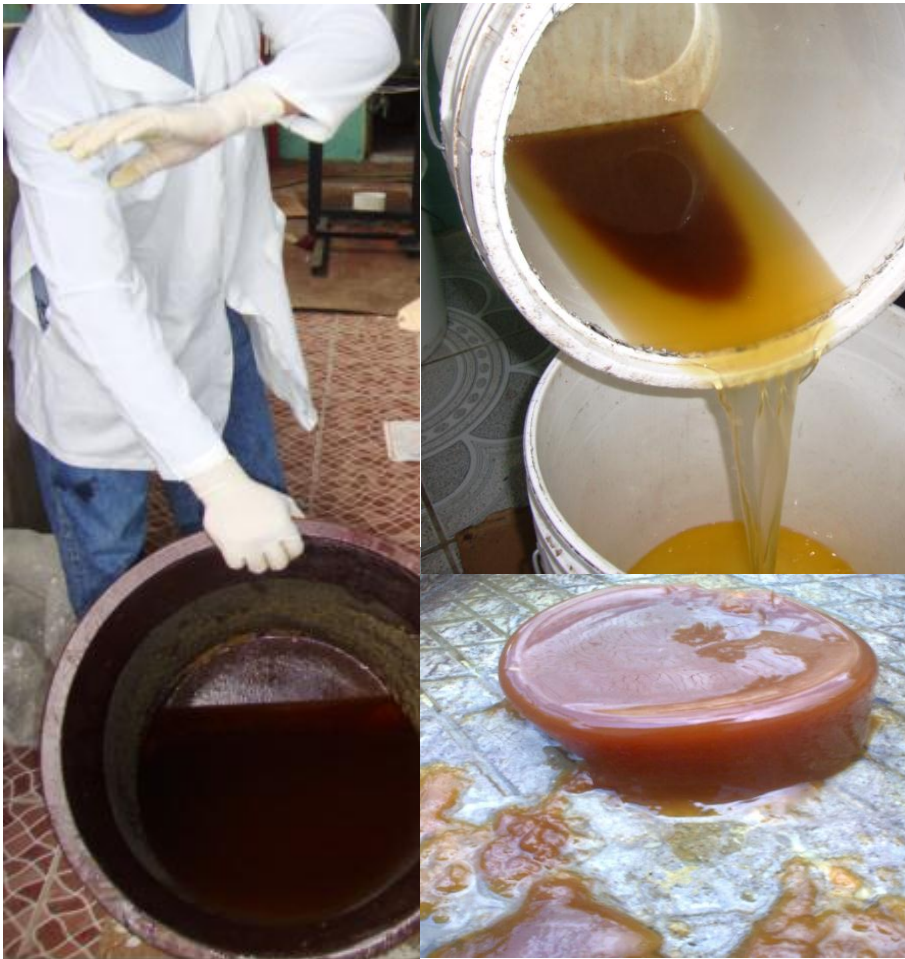
FIGURA 21. Separación del metiléster (2011-11-02)
