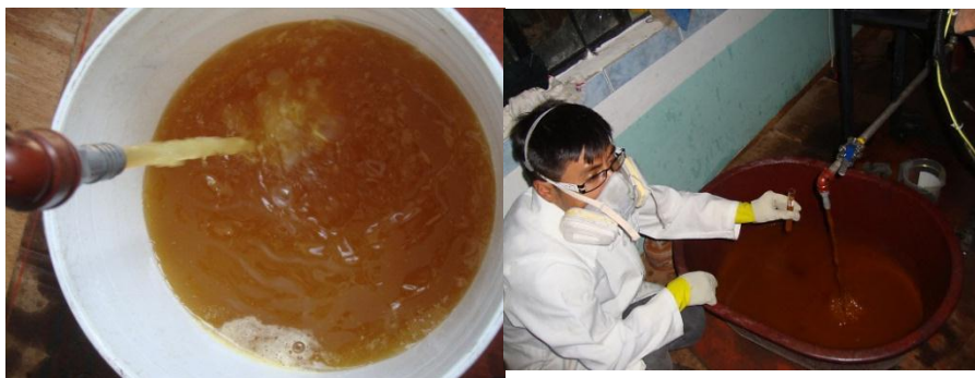
FIGURA 19. Descarga después de transésterificar (2011-09-16)
