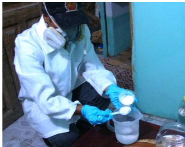
FIGURA 14. Preparación del metóxido de sodio (2011-09-16)
