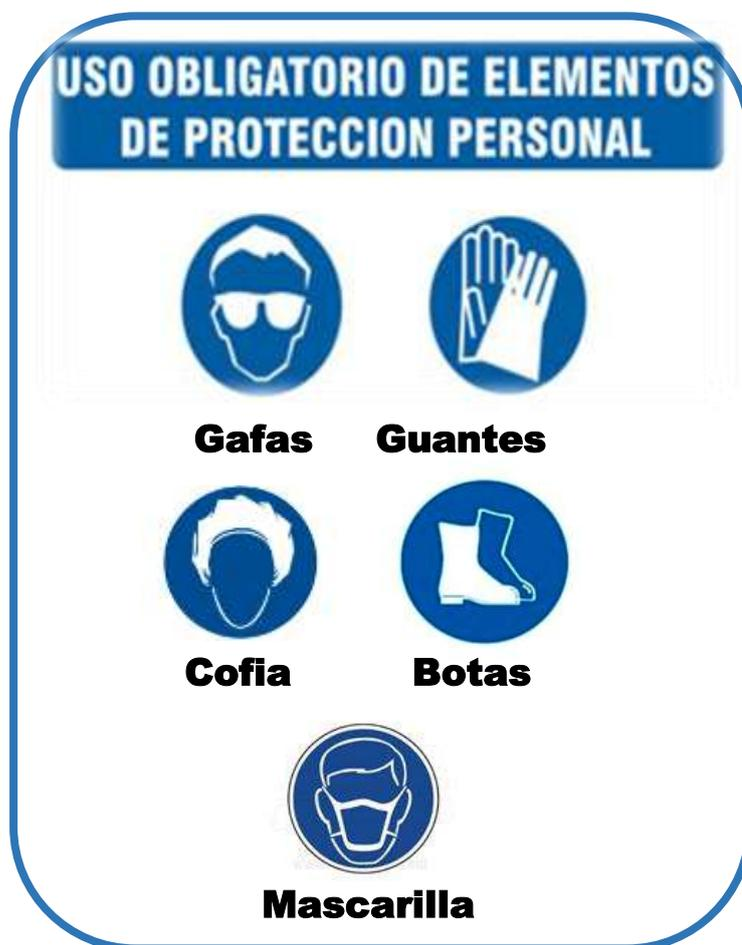
**FIGURA 4-14:** EPP para preparación de soluciones
