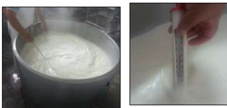
FIGURA 2.9: Proceso de Pasteurización (Queso)
