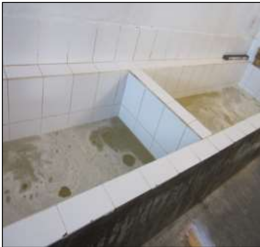
Figura. 23. Salero antiguo hecho de baldosa Fuente: Empresa “Productos Lácteos Yaznan”. Elaborado por: Mariela Cepeda
