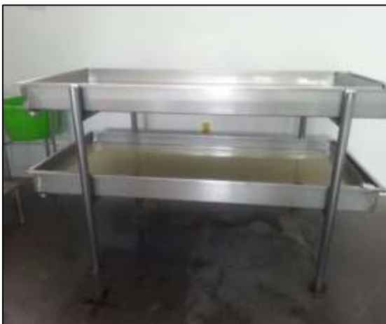
Figura. 1. Salero de material de acero inoxidable Fuente: Empresa “Productos Lácteos Yaznan”. Elaborado por: Mariela Cepeda
