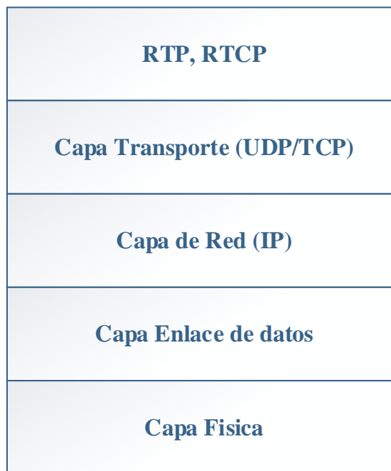
Figura 3. Estructura de protocolos de VoIP.
