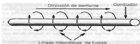
Figura 9: Principio de funcionamiento
