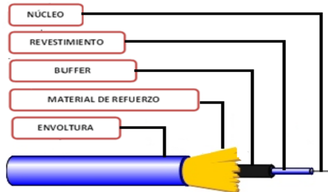
Figura 35. Estructura de la fibra óptica
