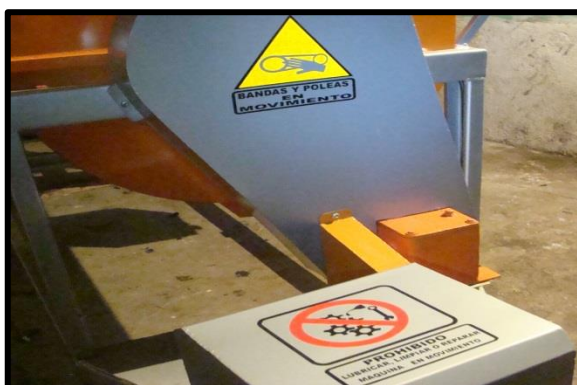
SEGURIDADES MOTOR Y BANDAS LAVADORA
