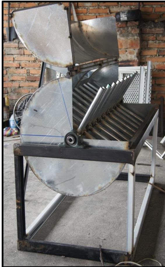
TANQUE DE LAVADO, EJE CENTRAL, ESTRUCTURA
