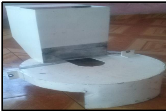
RANFLA DE ABASTECIMIENTO Y ÁREA DE CORTE
