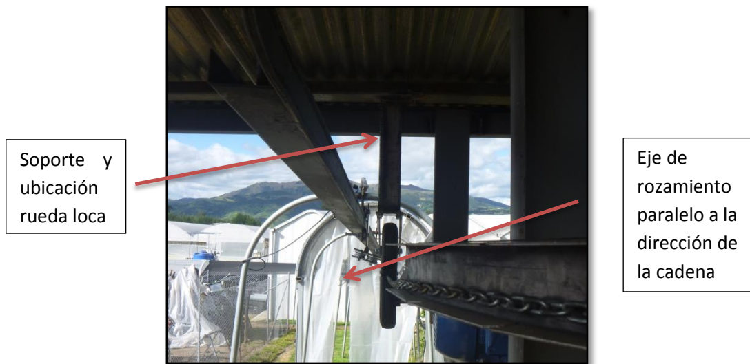
Figura 100: Ubicación soporte y rueda loca Fuente: Autor
