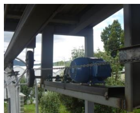
Figura 4. Sistema de tracción, accionamiento de la cadena de arrastre
