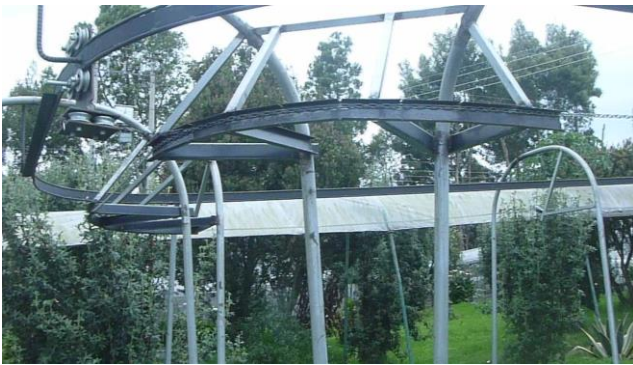
Figura 3. Sistema de transporte para coches con flores cortadas hacia el túnel de fumigación
