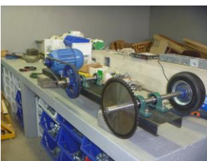
Figura 4. Sistema de tracción, accionamiento de la cadena de arrastre
