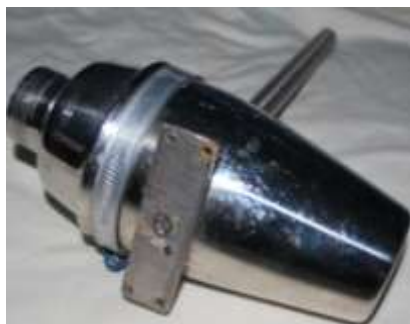
Figura 3. 10 Acople para el servomotor y el shaker
