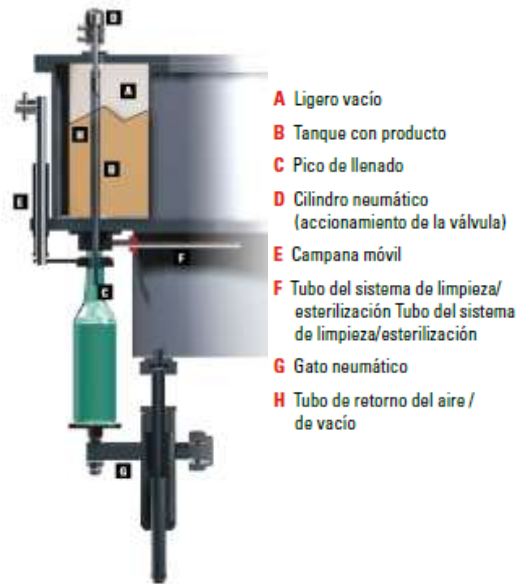
Figura 2. 19 Válvula de llenado a gravedad
