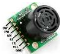
Figura 12 Conexión de los terminales Fuente: Hoja de datos del sensor XL-MaxSonar EZ4 , 2005
