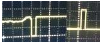
Figura 11 Salidas del pulso con dos Schmitt Trigger Disparador Inversores HD 74LS14
