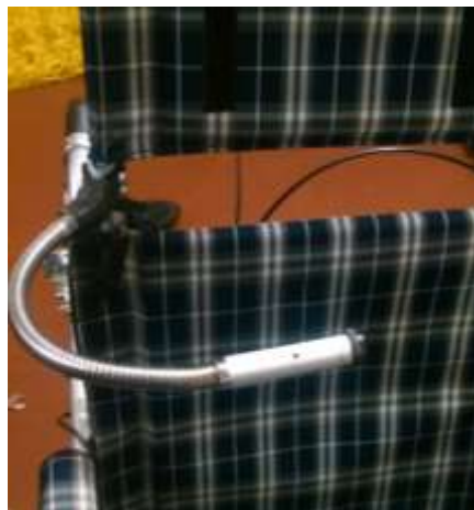
Figura 5.4. Sensor de paro de emergencia del sistema.
