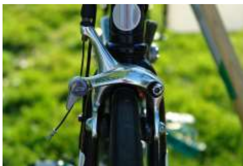
Figura 2.16. Freno de llanta de accionamiento lateral.
