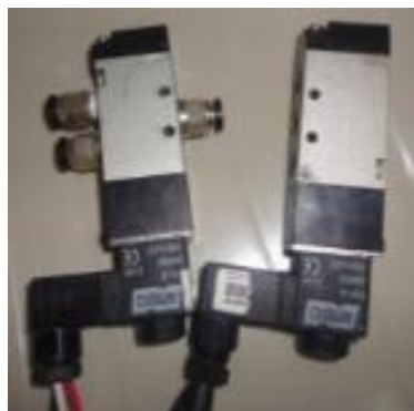
FIGURA 2.10 Electroválvula 5/2 con actuador eléctrico
