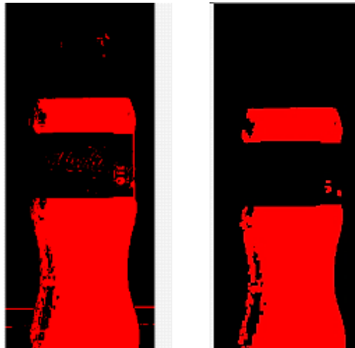
FIGURA 1.23 Detección de bordes a) Adelgazado b) Umbralado
