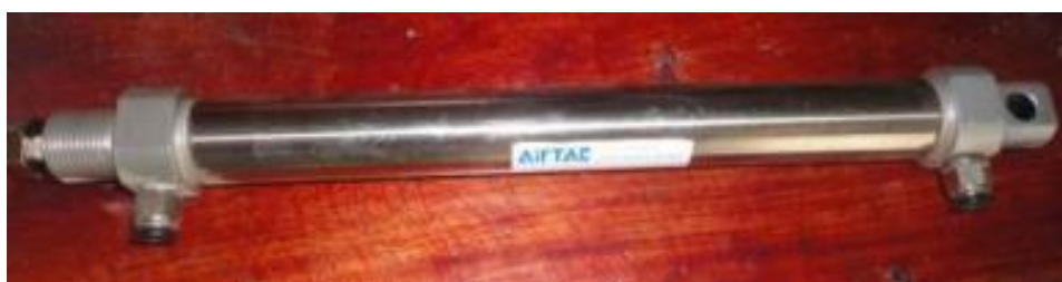
FIGURA 2.9 Cilindro neumático doble efecto carrera 20 [cm].
