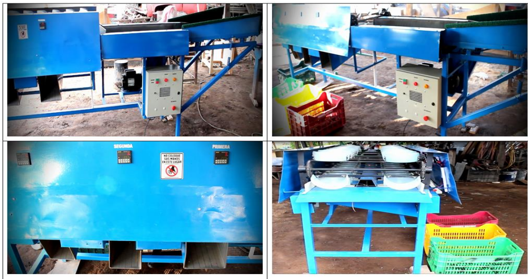
Figura 35.- Máquina para clasificar aguacates por su peso
