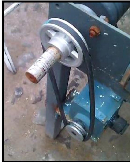
Figura 66. Instalación de polea y banda en V
