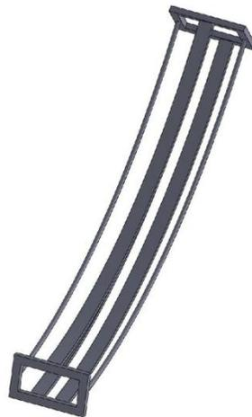
*Figura 21:* Guía de gravedad con varillas de acero inoxidable
