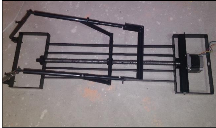
Figura 6.4 Ensamblaje preliminar del rehabilitador
