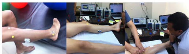
Fig. 22. Pruebas preliminares de funcionamiento de sistema SEMG.
