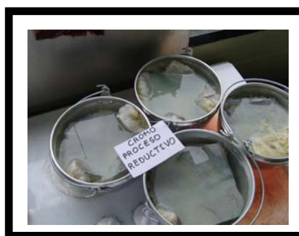
FOTOGRAFÍA 15: Proceso de blanqueo químico reductivo y blanqueo óptico.
