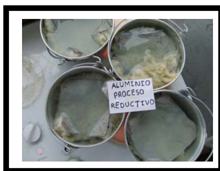
FOTOGRAFÍA 15: Proceso de blanqueo químico reductivo y blanqueo óptico.
