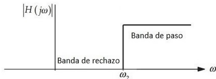
Figura 2.30 Respuesta ideal de magnitud-frecuencia filtro paso alto.
