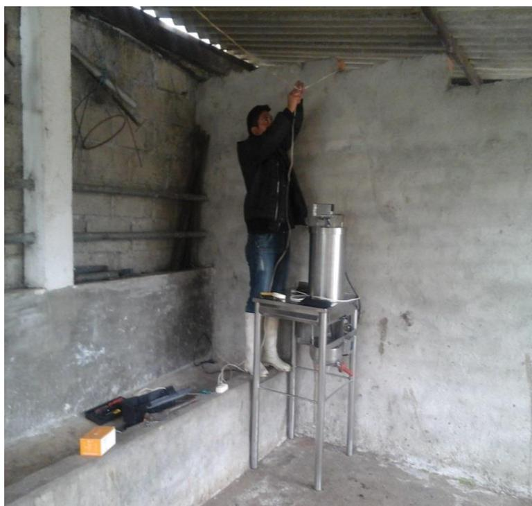
Foto 2 Instalación Máquina dosificadora de leche
