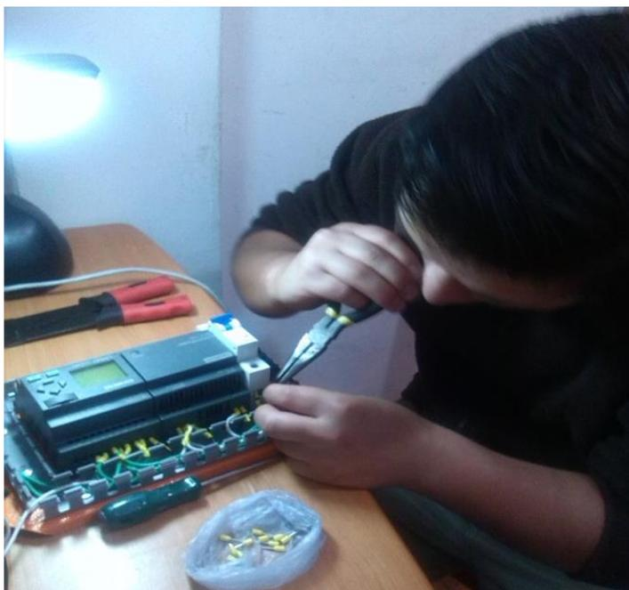
**Figura 4. 3 Conexiones de las entradas del PLC**
