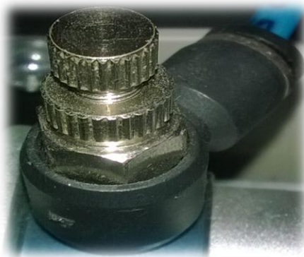
Figura 2-10 Regulador de caudal de la bomba dosificadora
