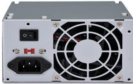
Figura 3-17 Fuente de alimentación Altexk Atx
