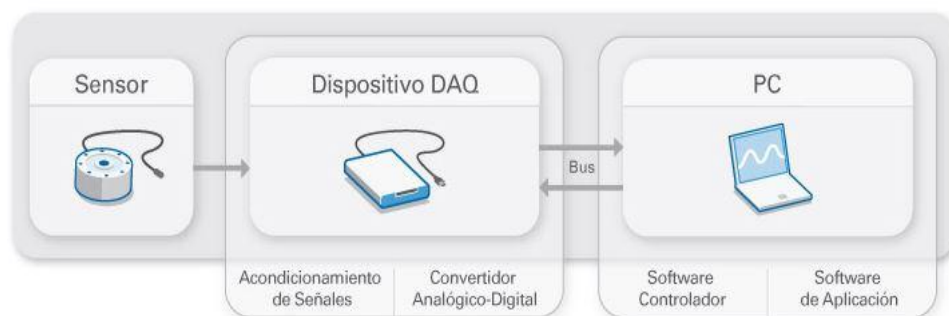
Figura 1-7 Partes de un sistema DAQ
