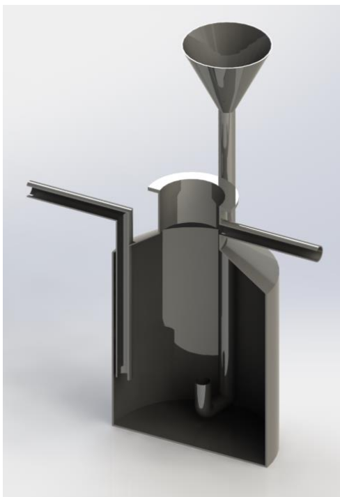
Figura 2.9 Decantador de aceite con florentino en corte
