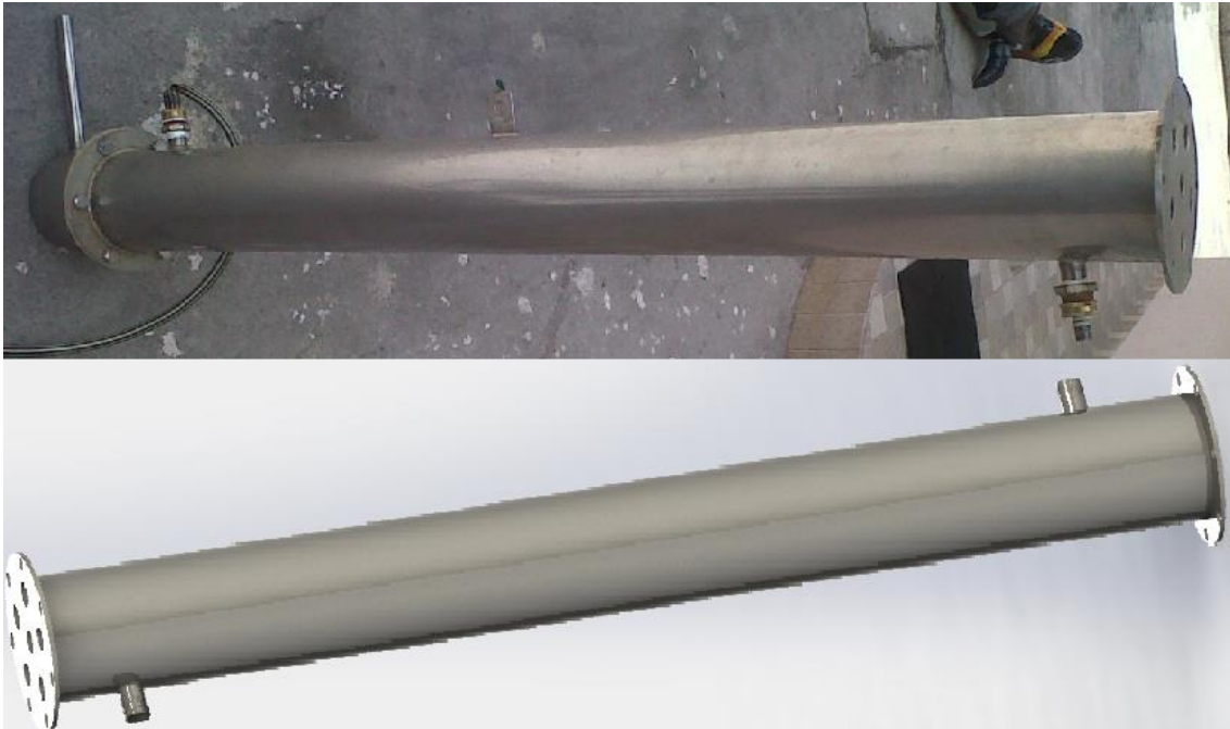
Figura 2.6 Intercambiador de calor de coraza y tubos de acero inoxidable
