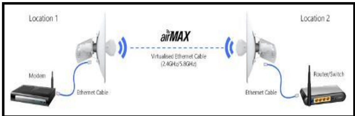
FIGURA 2-16: Estructura de la conexión de los radios NanoBridge M
