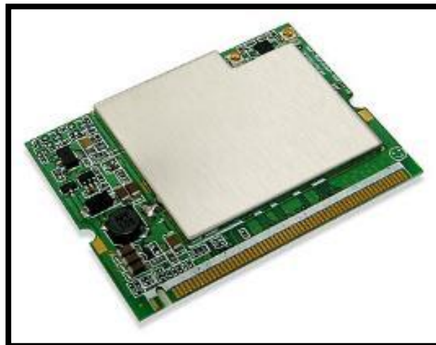
FIGURA 2-19: Estructura física de la miniPCI Atheros AR5413
