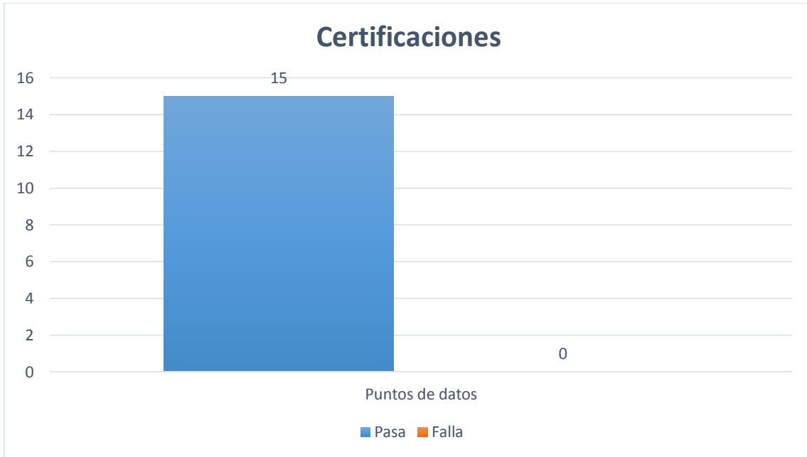
Figura 25. Certificación de los puntos cable cat. 6 Realizado por Esmeralda Patiño
