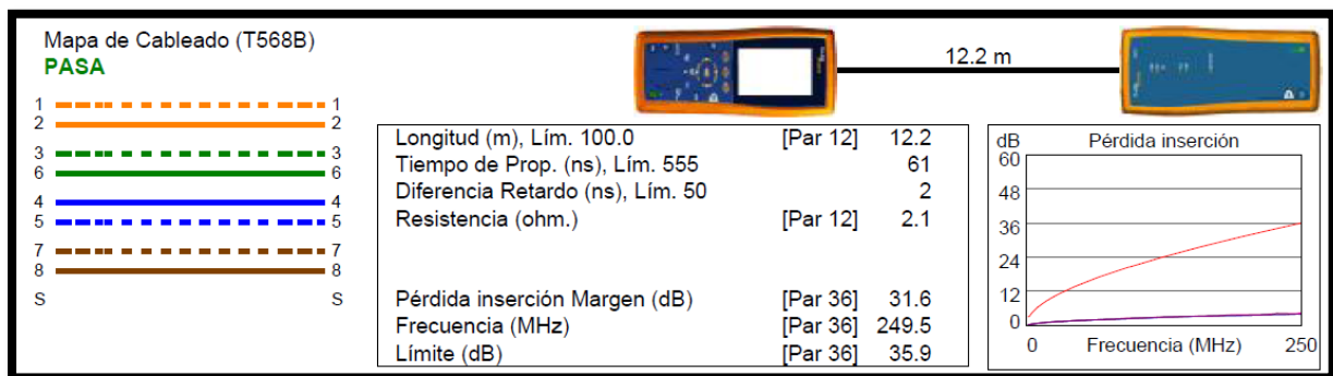
Figura 27. Análisis de parámetros certificación de punto de datos Fuente: Resultados de certificación software LinkWare versión 6.2
