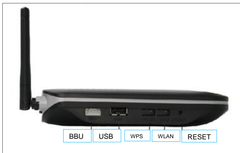
Figura 41. Puertos / Botones parte lateral ONT HG8245
