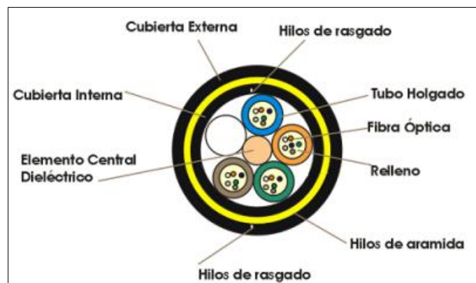
Figura 54. Descripción detallada fibra ADSS
