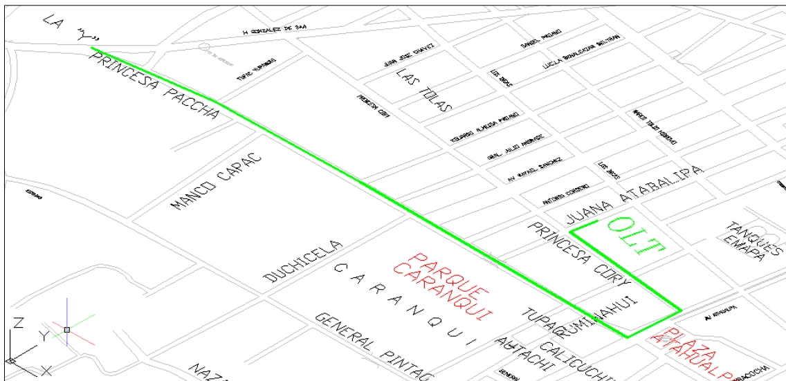
Figura 49. Recorrido canalización existente
