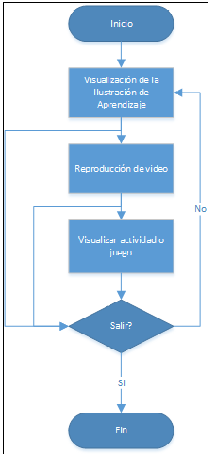
Figura 6: Proceso de funcionamiento de pantallas principales del Software 3D Fuente: Propia
