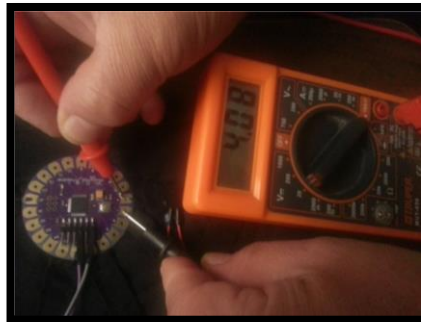
FIGURA 186: Voltaje out de placa Lilypad
