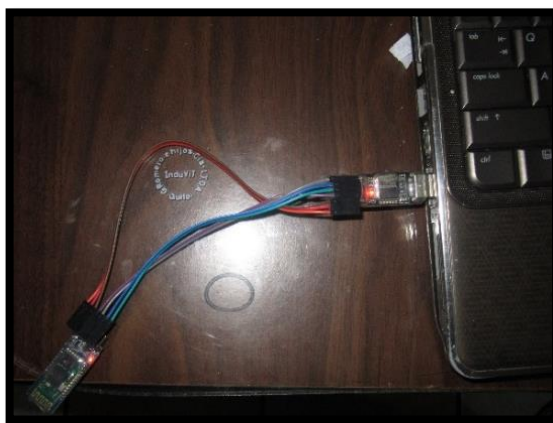
FIGURA 173: Conexión del USB-TTL al módulo Bluetooth
