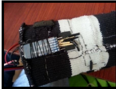
FIGURA 130: Conexión del módulo Bluetooth en la muñequera (prototipo#2)
