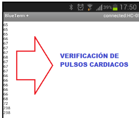
FIGURA 138: Verificación de pulsos cardíacos en prototipo#2
