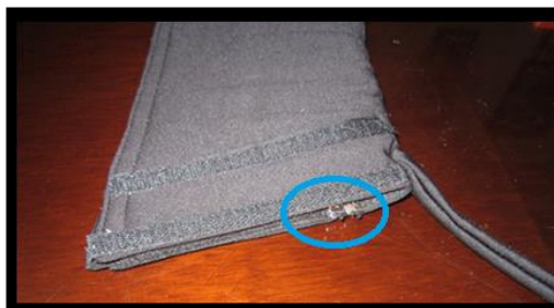
FIGURA 193: Ubicación de los switch en la muñequera
