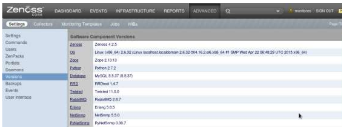
Fig-Zenoss 25. Paquetes instalados para el funcionamiento de Zenoss.
