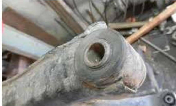
Figura 4.4.29 Adaptación de un buje en la parte inferior del amortiguador
