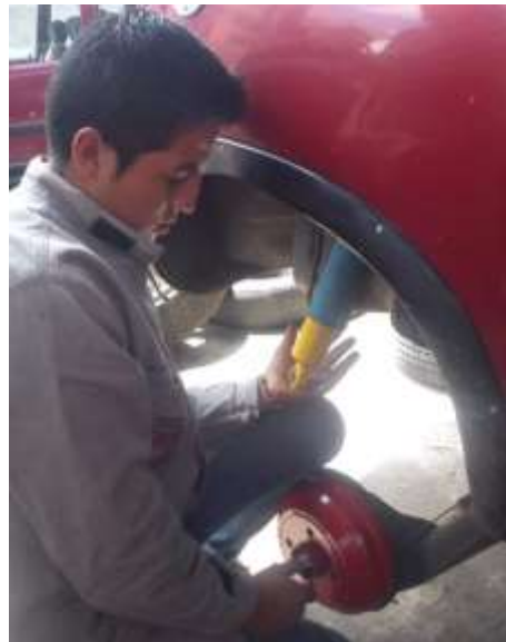
Figura 4.4.31 Compresión del amortiguador
