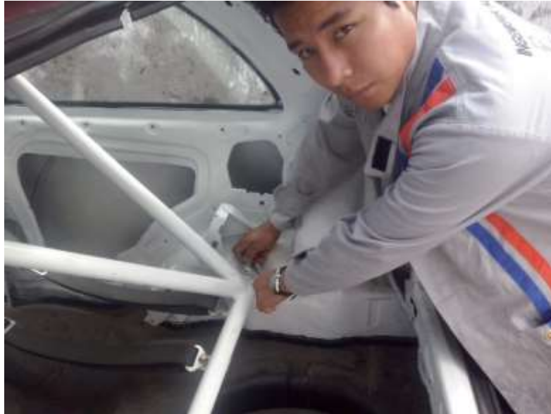
Figura 4.4.23 Aflojar los pernos de la torreta posterior
