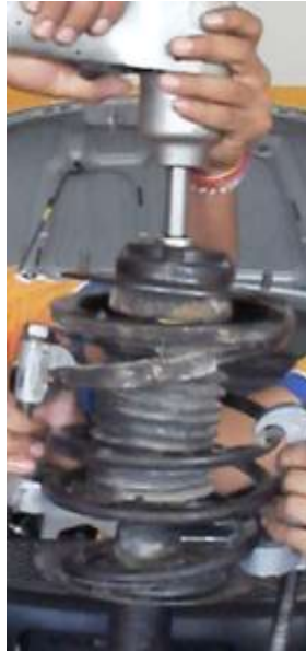
Figura 4.4.6 Aflojar la tuerca del vástago
