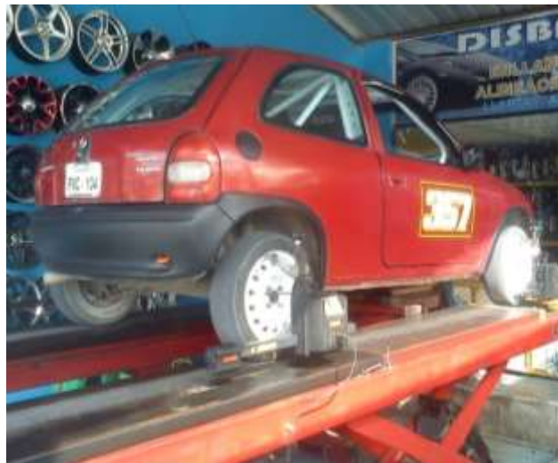
Figura 4.4.19 Colocación de sensores para la alineación
