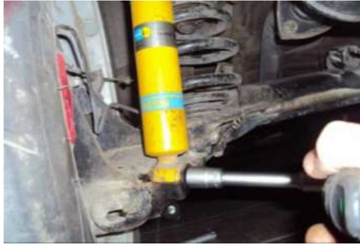
Figura 4.4.25 Aflojar el perno de sujeción inferior
