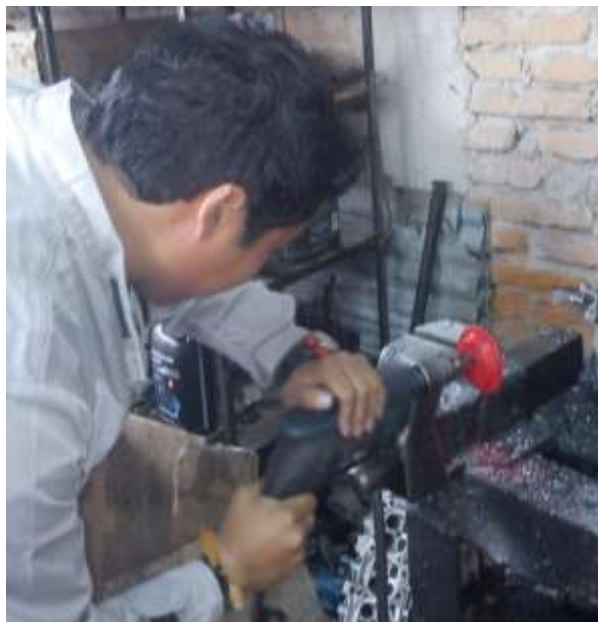
Figura 4.4.13 Adaptación de las bases superiores para los coilovers
