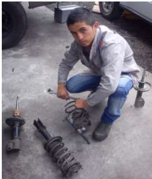
Figura 4.4.7 Separar el resorte del amortiguador
