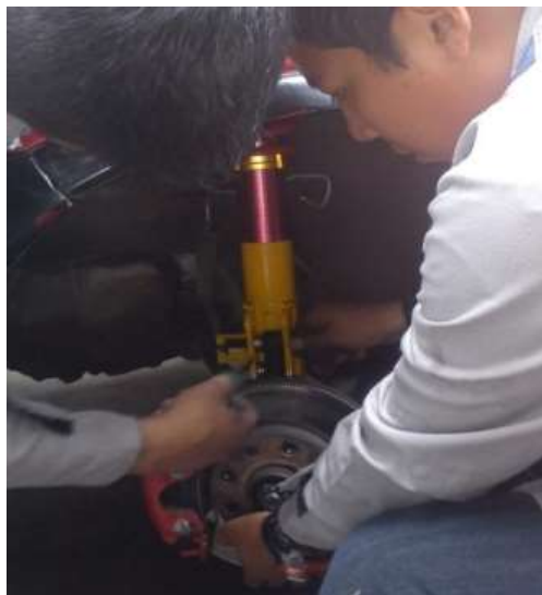
Figura 4.4.17 Acoplamiento de los coilovers
