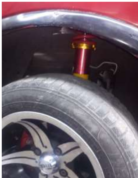
Figura 4.4.21 Coilovers colocados Fuente. Autores
