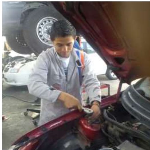
Figura 4.4.3 Aflojar los pernos de sujeción de la parte superior
