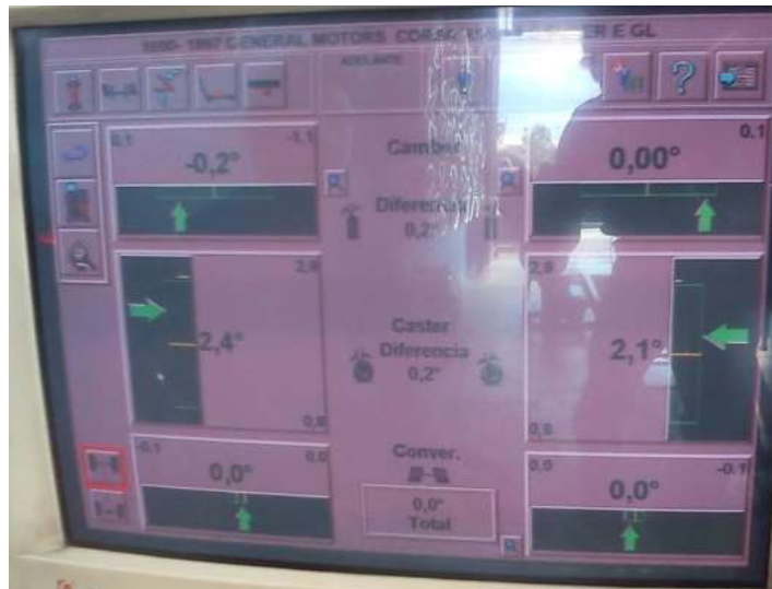
Figura 4.4.20 Alineación en computadora Fuente. Autores
