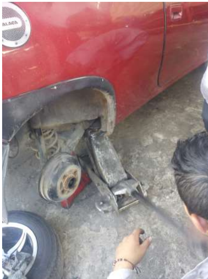
Figura 4.4.22 Desmontaje de la rueda posterior
