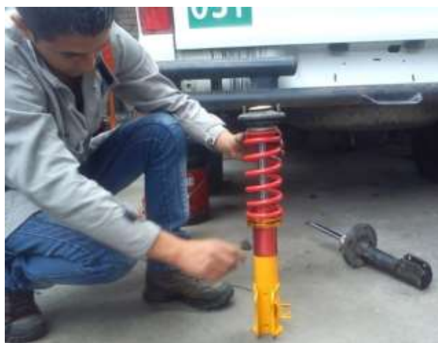
Figura 4.4.15 Acoplamiento de la sujeción superior
