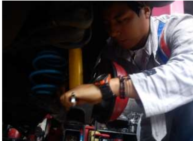
Figura 4.4.32 Fijación del amortiguador posterior
