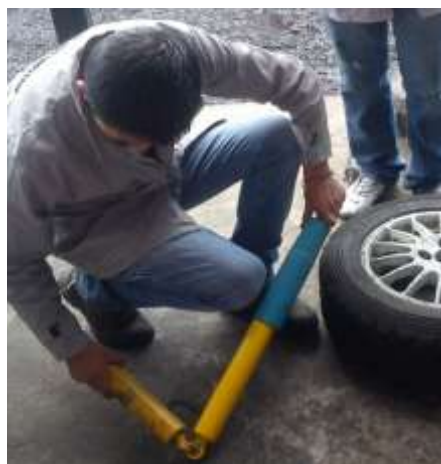
Figura 4.4.26 Sustitución del amortiguador estándar por uno más rígido
