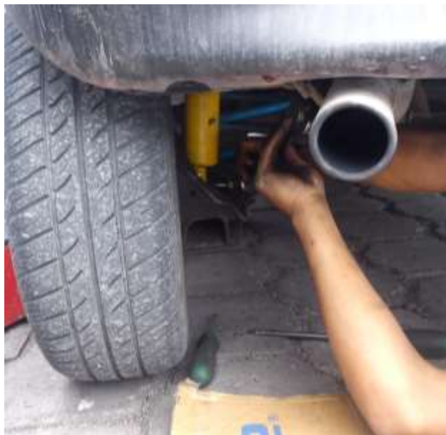
Figura 4.4.33 Cambio de amortiguador y llantas
