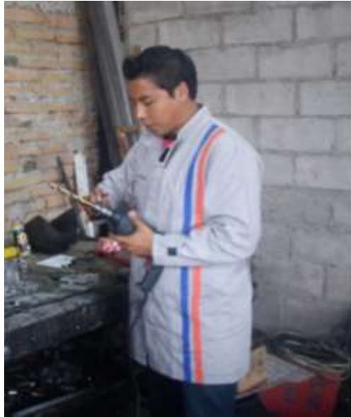
Figura 4.4.10 Cambio de brocas para las perforaciones
