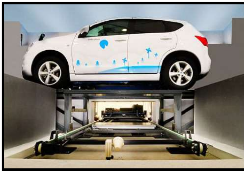
Figura 16. Sistema automático de intercambio de baterías.
