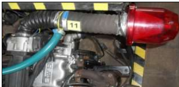
Figura 22. Ubicación y montaje del mezclador 11.
