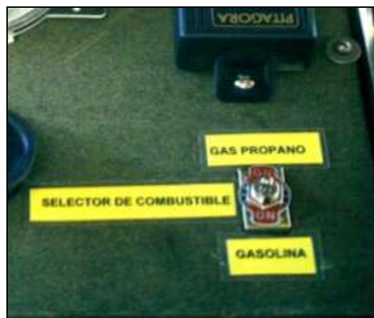
Figura 26. Ubicación del selector de combustible
