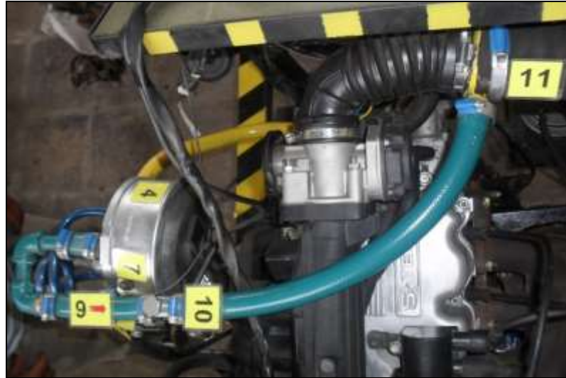
Figura 23. Ubicación y montaje de la manguera del mezclador Fuente. (Autores, 2014)
