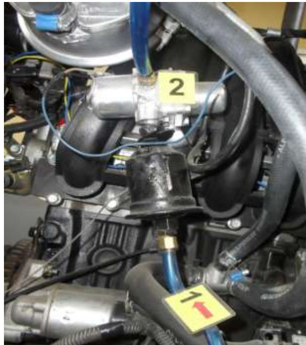
Figura 24. Ubicación y montaje de la electroválvula de gas Fuente. (Autores, 2014)
