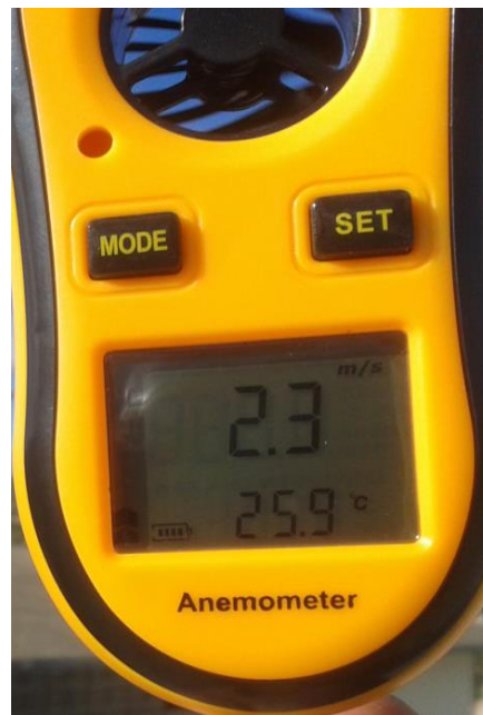
Figura 12. Anemómetro donde registra la velocidad del viento y la temperatura.
