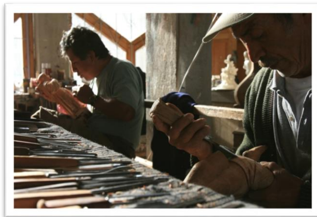
Ilustración: Trabajos con gurbia
