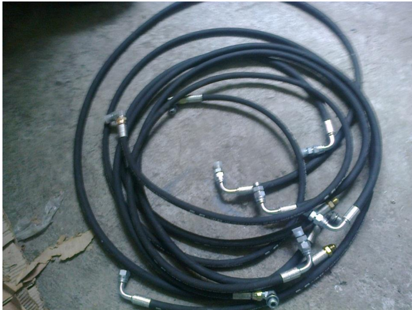
Cañerías de alta presión.
