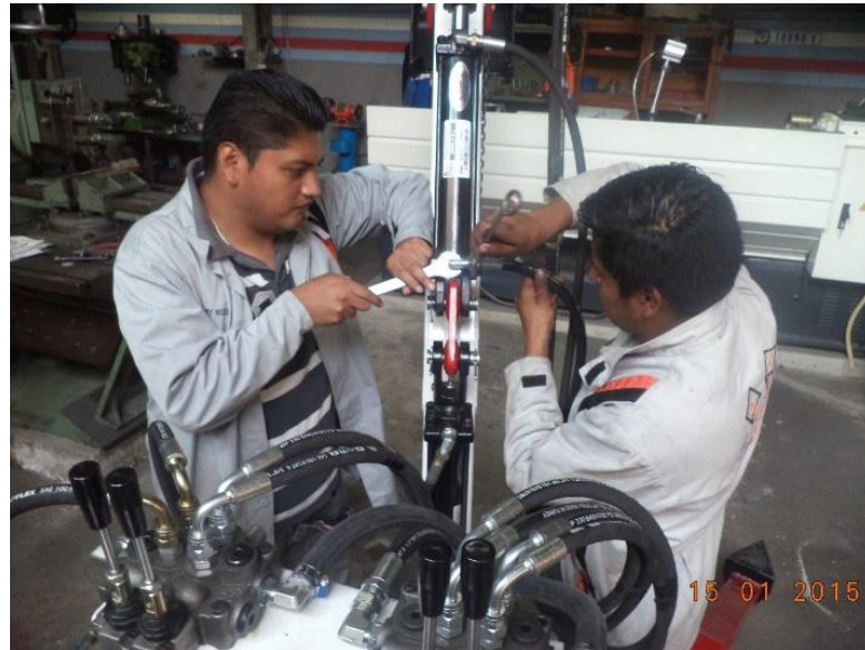
Figura 32. Instalación cañerías de alta presión.
