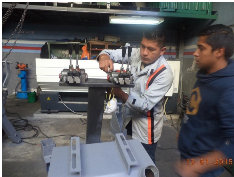
Montaje de los mandos mecánicos.
