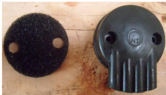
Figura 69. Filtro de aire
