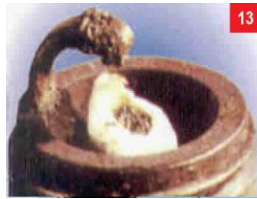
Figura 67. Bujía con sobrecalentamiento Fuente: (Bujías de Encendido, 2015)
