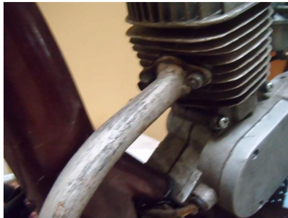
Figura 45. Previa instalación del tubo de escape
