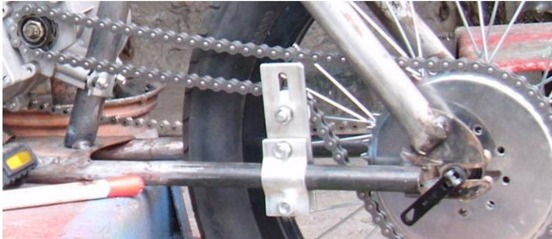
Figura 50. Instalación de cadena y tensor
