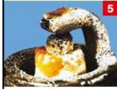
Figura 66. Bujía con exceso de plomo Fuente: (Bujías de Encendido, 2015)
