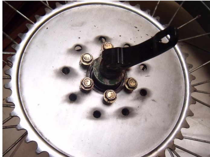
Figura 48. Instalación del piñón
