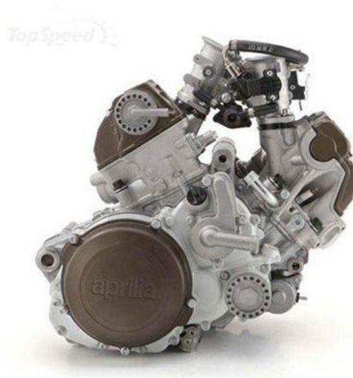
Figura 5. Motor dos tiempos Fuente: (Motosonline, 2013)
