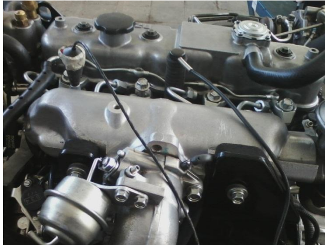
Figura 16. Conexión de sensores en el motor.
