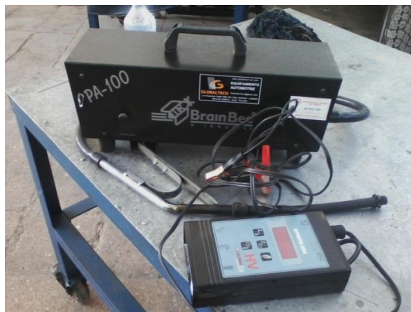
Figura 13. Conexión de elementos y dispositivos del opacímetro
