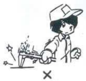
Figura 29: No utilizar el calibrador vernier para golpear.
