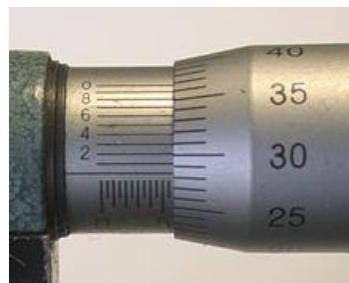
Figura 47: Ejemplo de lectura de un micrómetro con nonio en sistema métrico.
