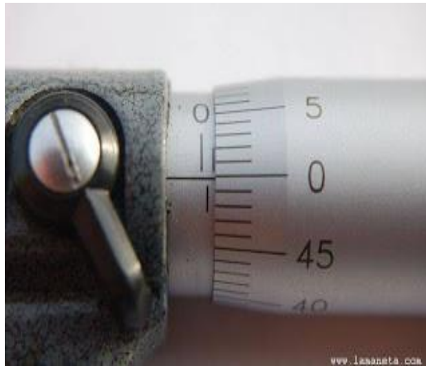
Figura 44: Ejemplo 1 de lectura de un micrómetro en el sistema métrico.
