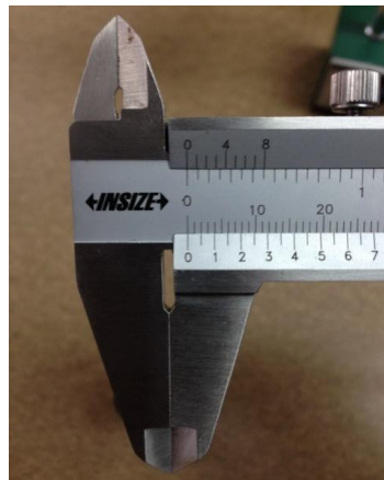
Figura 20: Verificando el contacto nivelado.
