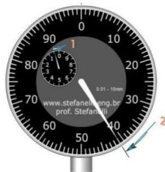
Figura 62: Ejemplo de lectura en el sistema métrico.
