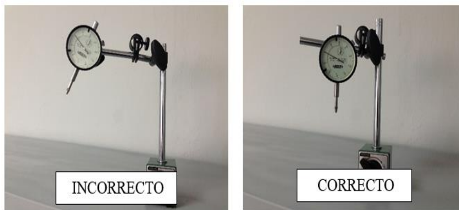
Figura 60: Posición de un reloj comparador en una base magnética.
