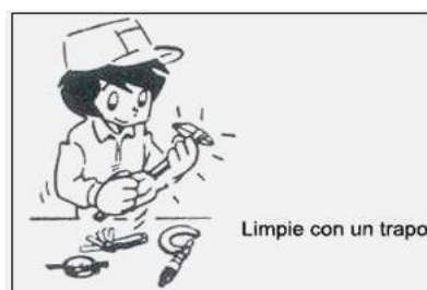
Figura 38: Limpieza de un micrómetro.
