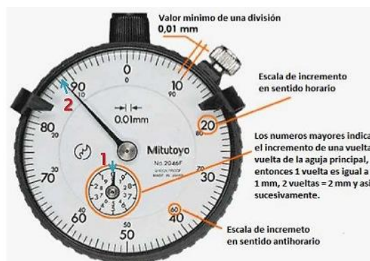
Figura 61: Procesos de lectura de un reloj comparador.
