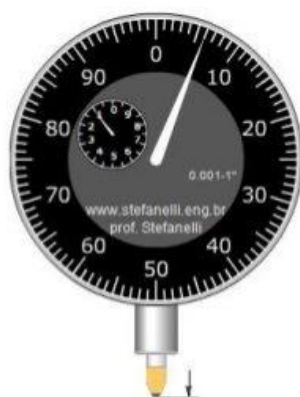
Figura 63: Ejemplo de lectura en el sistema inglés.
