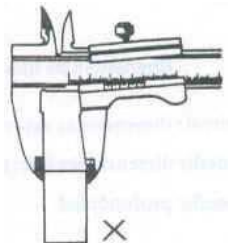
Figura 23: Posición incorrecta del vernier.
