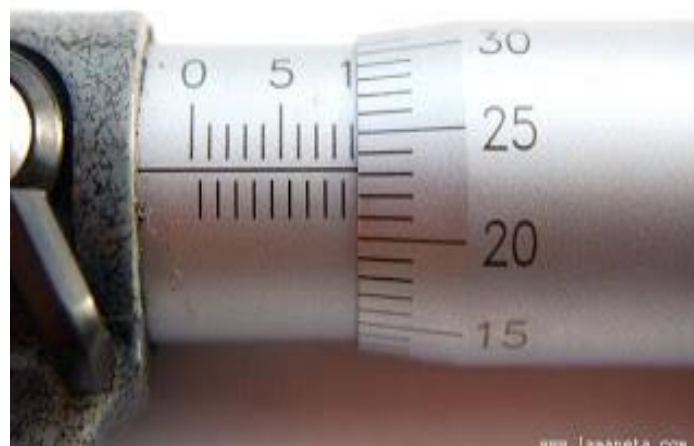
Figura 45: Ejemplo 2 de lectura de un micrómetro en el sistema métrico.
