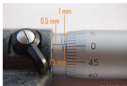
Figura 43: Escala de un micrómetro en el sistema métrico.
