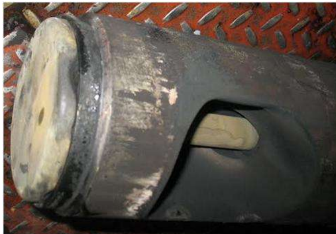
Figura 20.- Avería en block de escape, cilindro 6B
