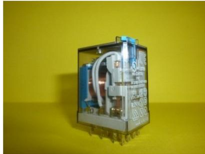
Figura N° 6: Relé con bobina a 110v.
