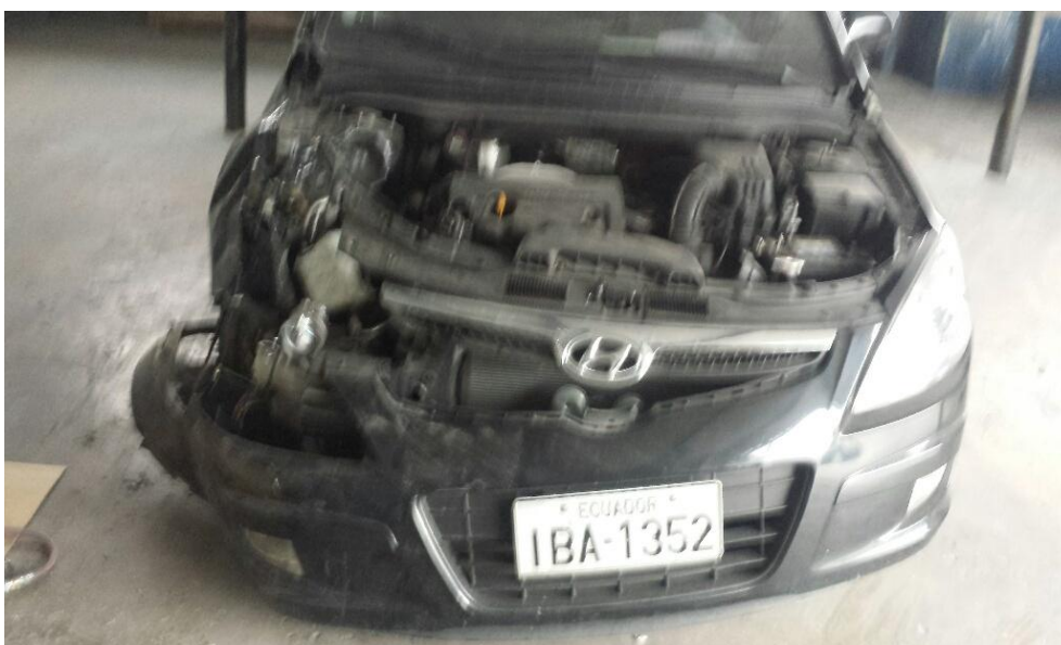
Figura 31. Parte afectada del vehículo Hyundai I30
