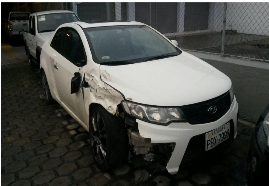
Figura 39. Localización de daños en el vehículo
