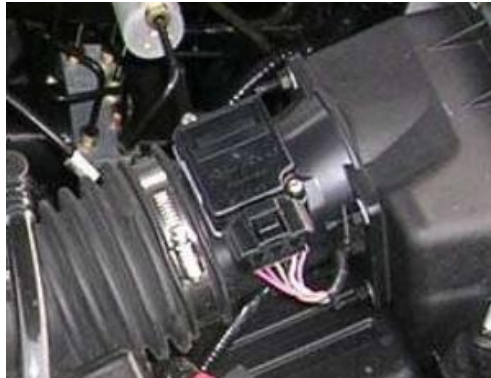
Figura 14. Ubicación del sensor MAF Fuente, (Autor, Bosch, 2009)
