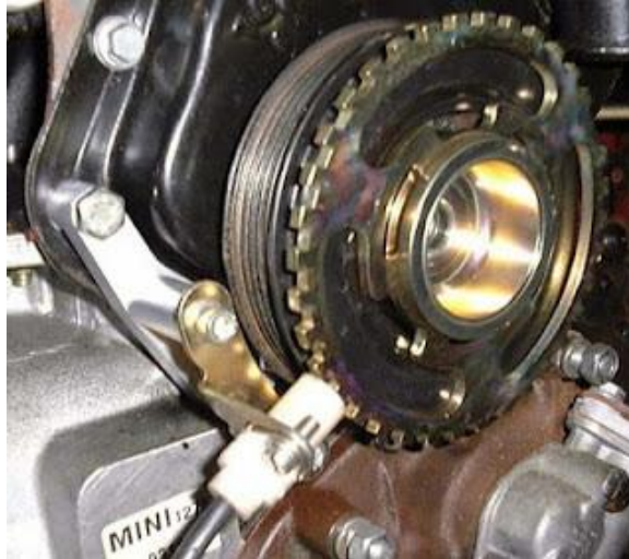
Figura 10. Ubicación del sensor de posición del cigüeñal Fuente (Autor, Luis Salcedo, 2008)
