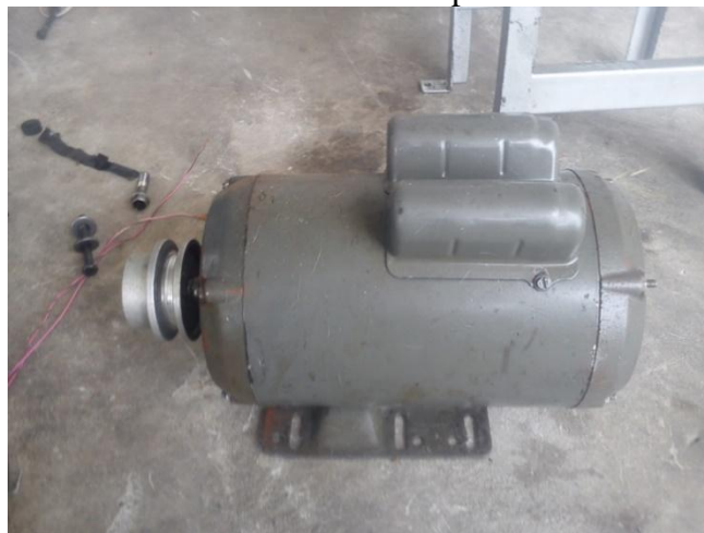
Motor eléctrico monofásico AC de 2HP utilizado para dar movilidad a la bomba VP44
