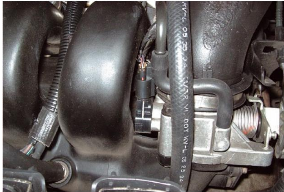
Figura 6. Sensor de posición del acelerador Fuente (Conevyt, 2010)
