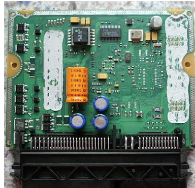
Figura 22. Componentes electrónicos de la ECU Fuente. (Pablo Balderas, 2012)
