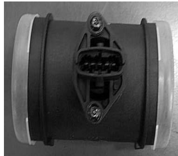
Figura 46. Sensor de flujo de aire (MAF)
