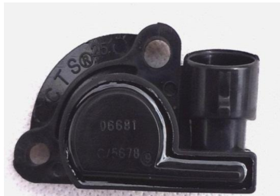
Figura 5. Sensor de posición del acelerador Fuente, (Autor, Dani Meganeboy, 2010)
