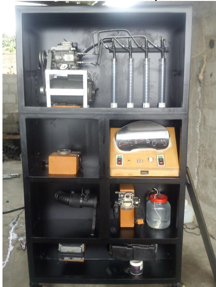
Motor eléctrico monofásico AC de 2HP utilizado para dar movilidad a la bomba VP44
