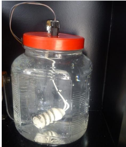
Figura 37. Simulación del sensor ECT
