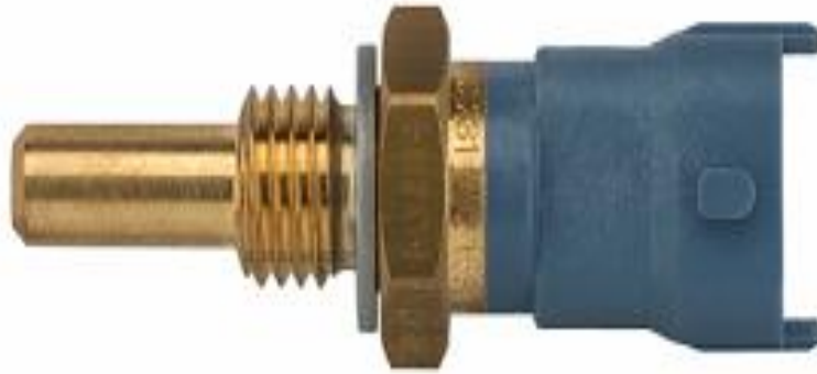
Figura 1. Sensor de temperatura del líquido refrigerante. Fuente (Multicentro Automotriz, 2013)
