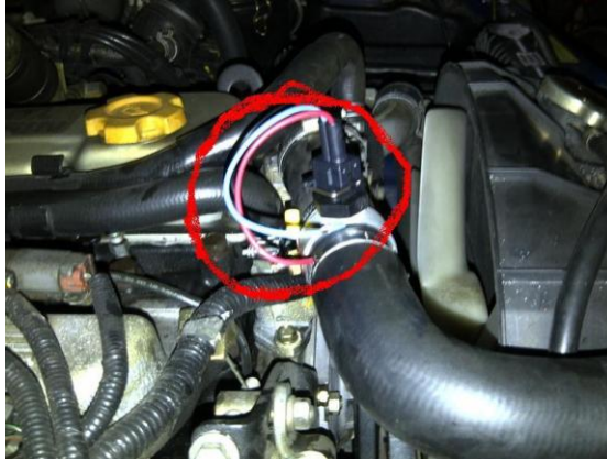
Figura 2. Ubicación del sensor ECT Fuente, (Patagonia off Road, 2010)
