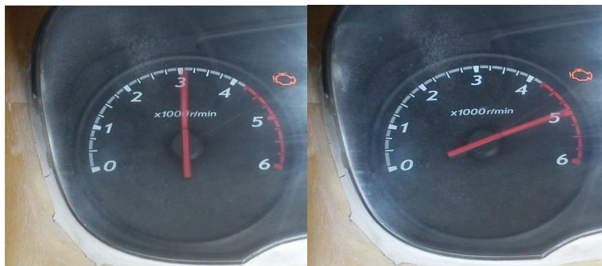
Figura 32. Medición de las revoluciones en el tacómetro
