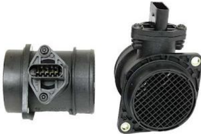
Figura 13. Sensor de masa de aire aspirado MAF Fuente (Bosch, 2009)
