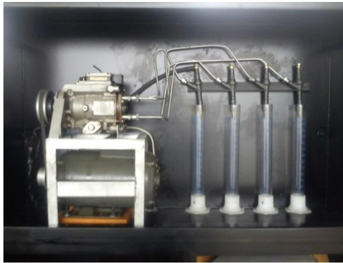
Figura 26. Colocación del sistema de inyección.
