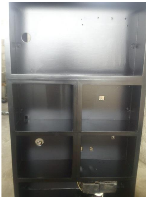
Figura 24. Tablero listo para montar los equipos
