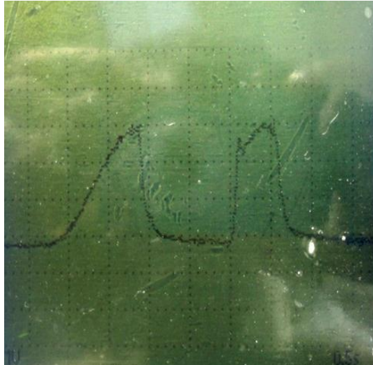
Gráfica 11. Curva del sensor MAF- IAT con el osciloscopio
