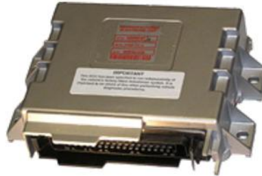
Figura 20. Módulo de control electrónica ECM Fuente (Nossovitch. P 2010.)
