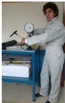
Figura 62. Instalación de inyector en la bomba manual
