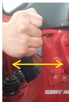
Figura 129. Movimiento del acelerador de trabajo
