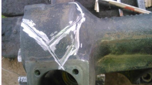
Figura 85. Corte de la moladora sobre la caja de la dirección.
