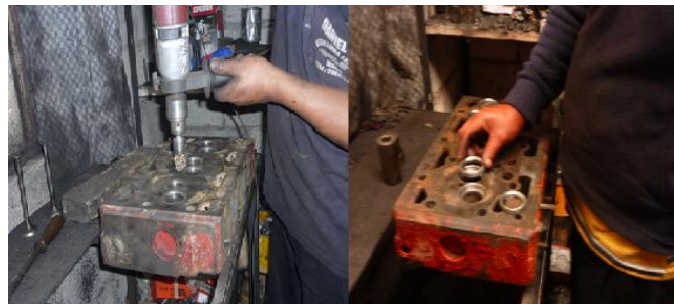
Figura 47. Colocación de asientos de válvulas.
