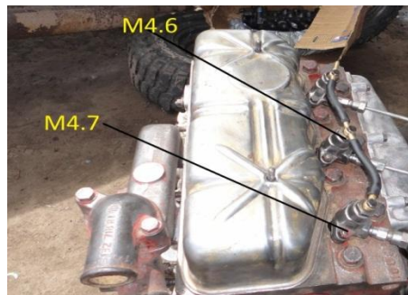
Figura 38. Retirando los inyectores.
