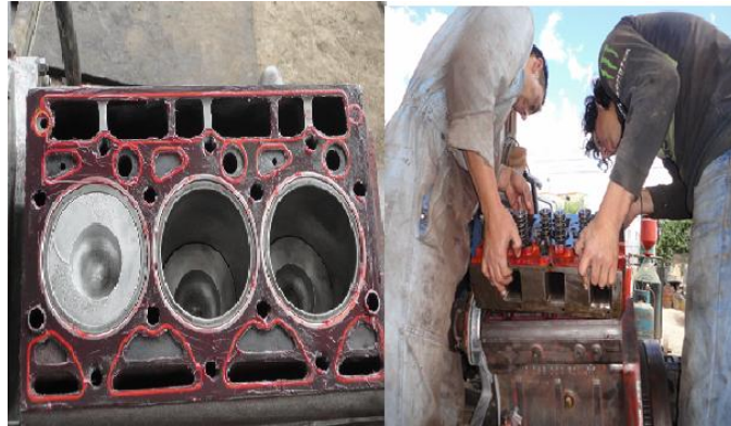
Figura 68. Empaque con shela y sentando el cabezote
