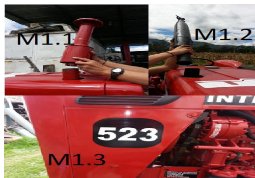
Figura 34. Desmontaje del capot.
