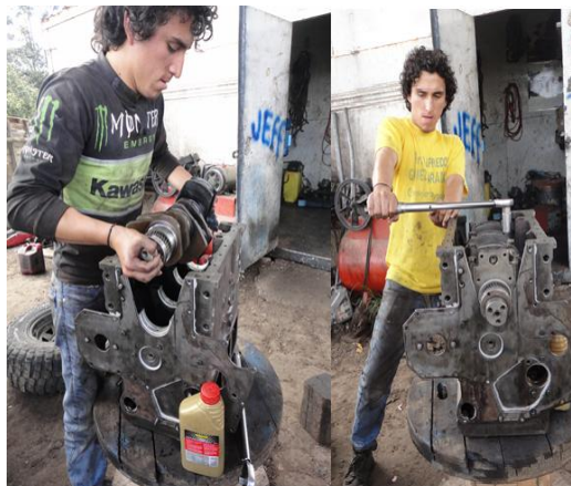
Figura 66. Montaje y torque del cigüeñal.
