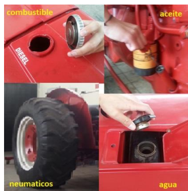
Figura 120. Parámetros de revisión
