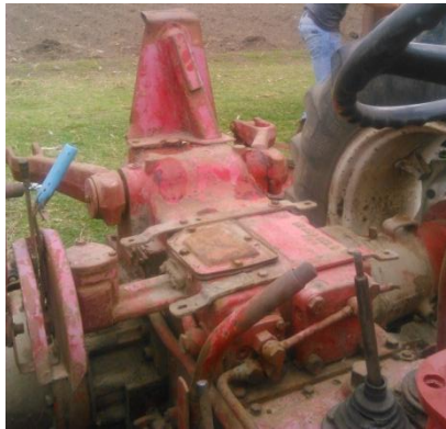
Figura 23. Estado visual de la transmisión.
