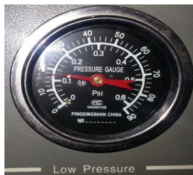
Figura 55. Presión de la cámara de la bomba. (Presión Atmosférica)
