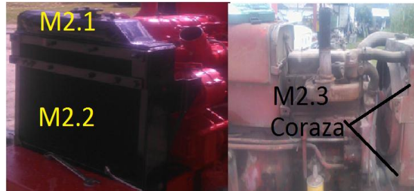
Figura 35. Desmontaje y montaje del radiador y coraza.
