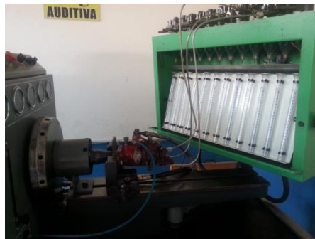
Figura 49. Bomba de inyección sobre el banco de pruebas.
