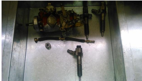
Figura 48. Bomba de inyección e inyectores
