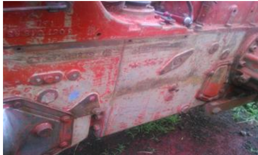
Figura 108. Costado izquierdo del tractor lijado.
