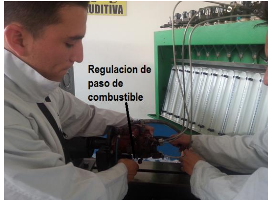
Figura 56. Calibración de la bomba de inyección
