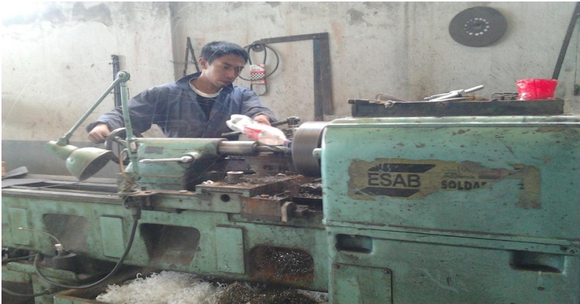
Reducción de diámetro del eje
