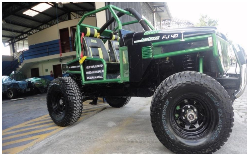
Figura 58: Toyota FJ40 tipo arenero con suspensiones independientes.
