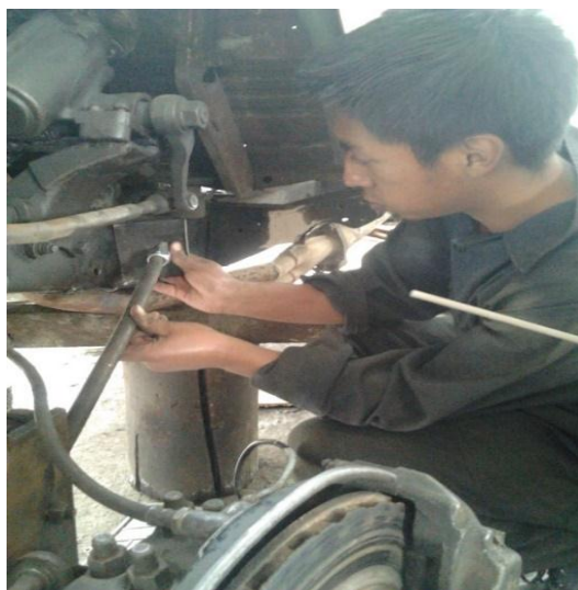
Figura 56: Colocación de barra de torsión.
