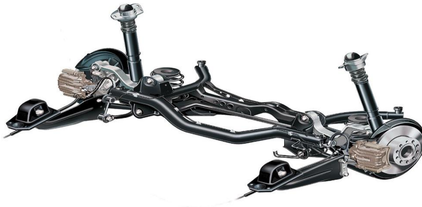
Figura 13: Suspensión Independiente Multibrazo.
