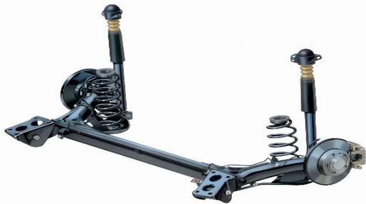
Figura 12: Suspensión Independiente de Brazos Tirados.
