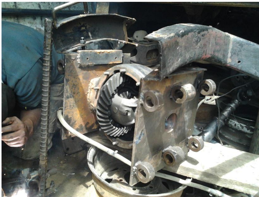
Figura 52: Montaje de bases de la suspensión y conjunto diferencial.
