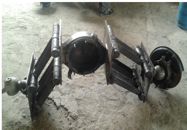
Figura 48: Mecanismo paralelogramo deformable de suspensión.
