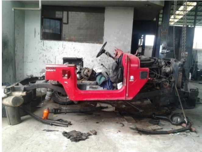
Figura 34: Desmontaje sistema de suspensión.
