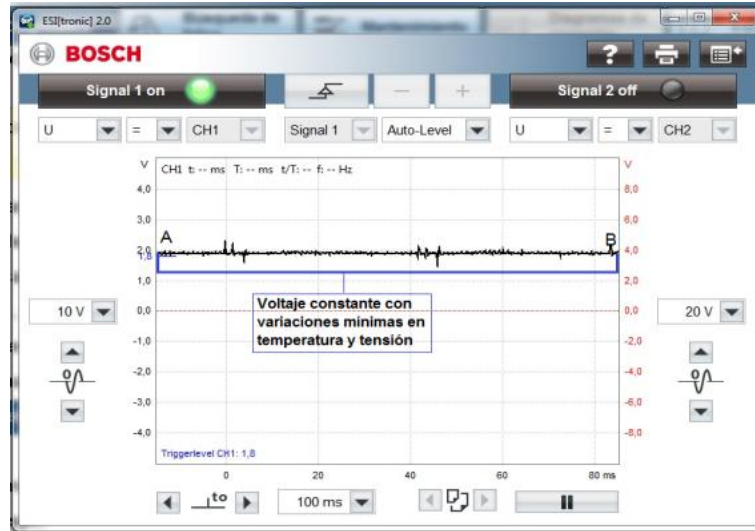
Figura 94. Onda de la señal del sensor ECT obtenida con el osciloscopio.
