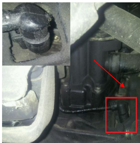
Figura 47. Ubicación del sensor de posición del cigüeñal.
