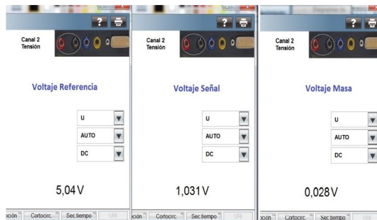
Figura 43.Voltaje del sensor de presión del Rail.
