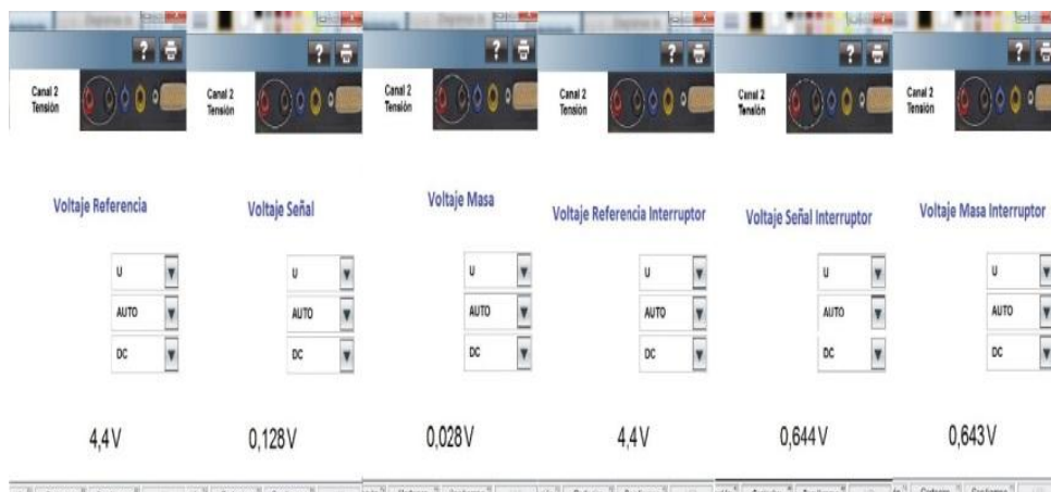
Figura 75. Voltaje del sensor de posición del pedal del acelerador
