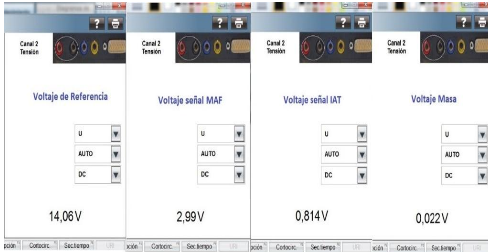
Figura 67. Voltaje del sensor de masa de aire
