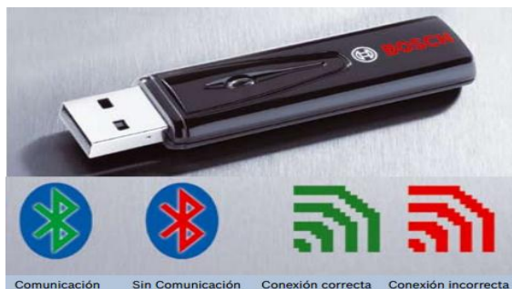
Figura 31. Adaptador USB Bluetooth e indicador luminoso de la función en el PC.
