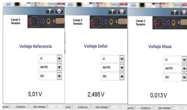
Figura 48. Tensión del sensor de posición del Cigüeñal.
