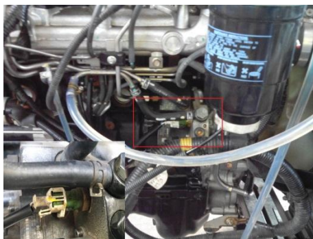
Figura 106. Ubicación del sensor de temperatura del combustible.
