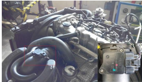
Figura 96. Ubicación del sensor MAF.
