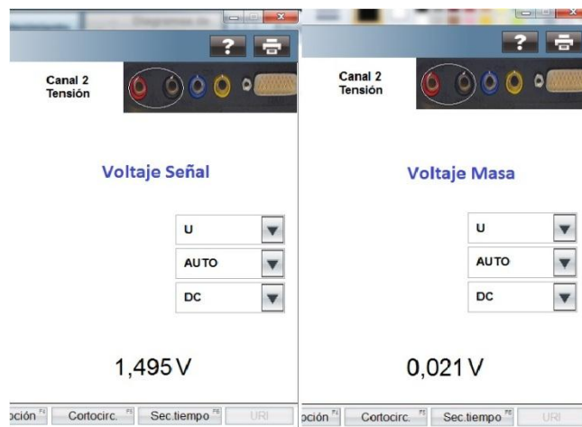
Figura 58.Tensión del sensor de temperatura de combustible.
