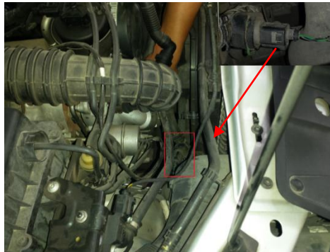
Figura 62. Ubicación del sensor de temperatura del líquido refrigerante.
