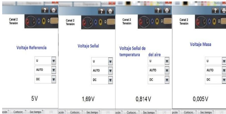
Figura 71. Voltaje del sensor de presión del tubo de admisión
