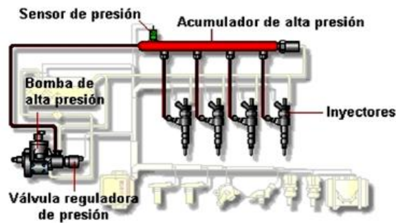
Figura 27. Circuito de alta presión. Fuente: (Bosch, Sistema CRDi, 2009)
