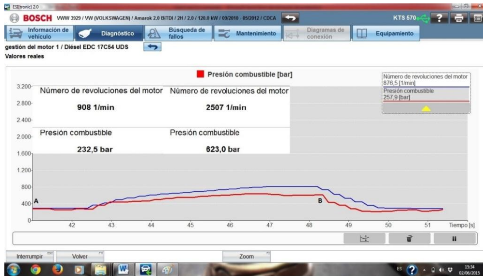
Figura 45. Valores reales del sensor de presión del Rail.
