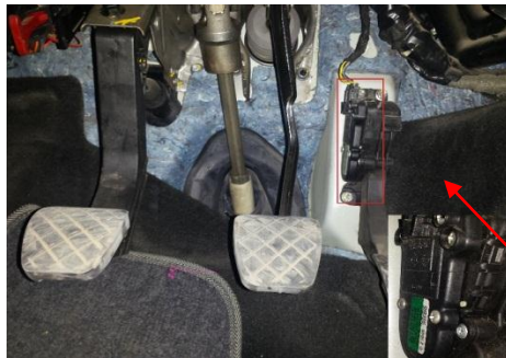
Figura 74. Ubicación del sensor de posición del pedal del acelerador
