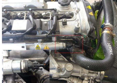
Figura 87. Ubicación del sensor de presión del riel.
