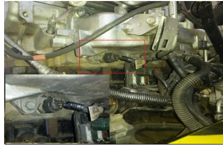
Figura 91. Ubicación del sensor de temperatura del refrigerante.
