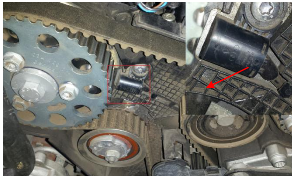
Figura 52. Ubicación del sensor de posición del árbol de levas CMP.
