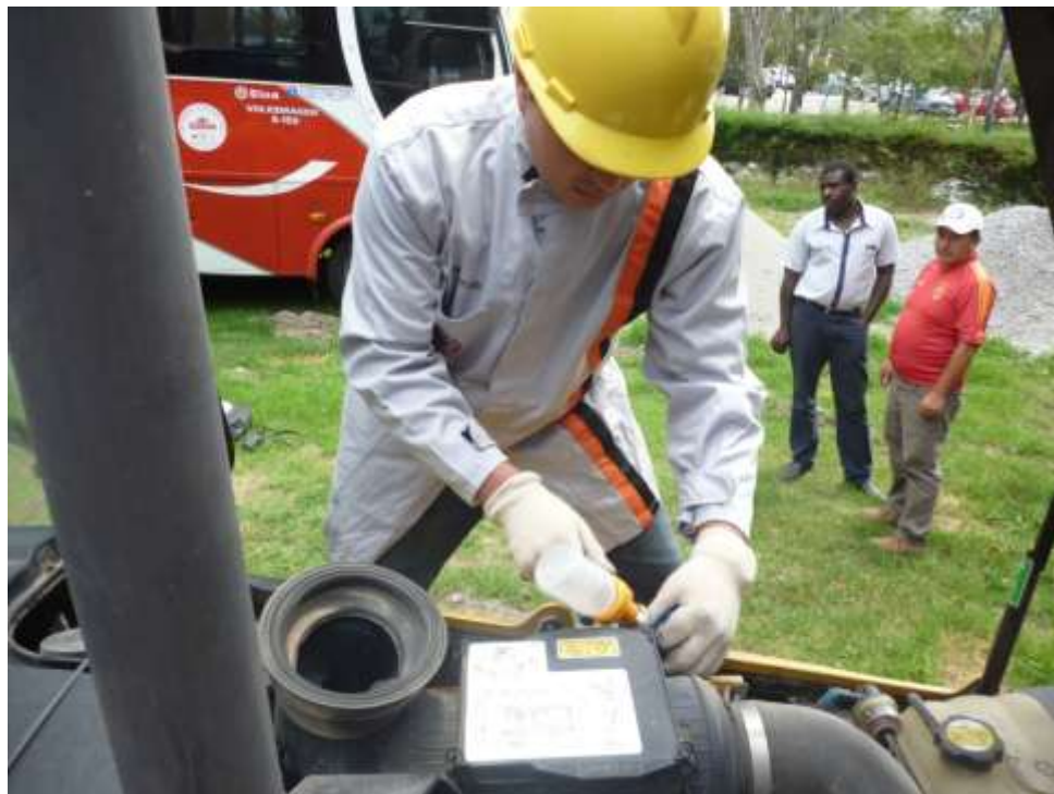
Realizando el muestreo de aceite a la gallineta de la UTN.
