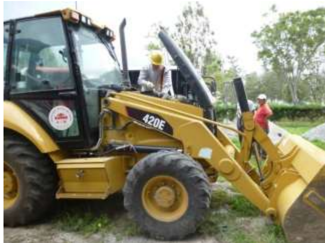
Figura 19. Verificando las entradas de aire.
