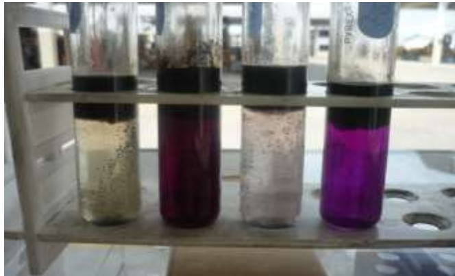
Figura 14. Presencia de refrigerante en el aceite.
