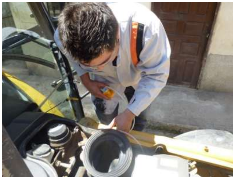
Implantando la manguera hacia el interior del cárter para realizar la extracción de aceite.
