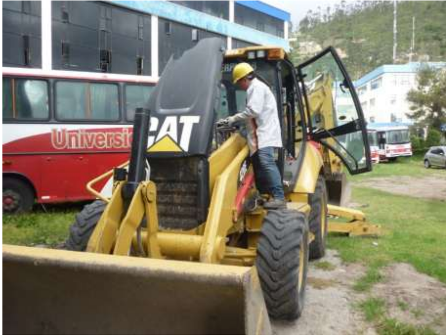
Limpiado el motor para realizar la toma de muestras de aceite.
