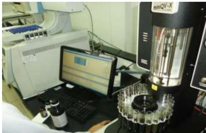
Figura 8. Prueba de viscosidad del lubricante.
