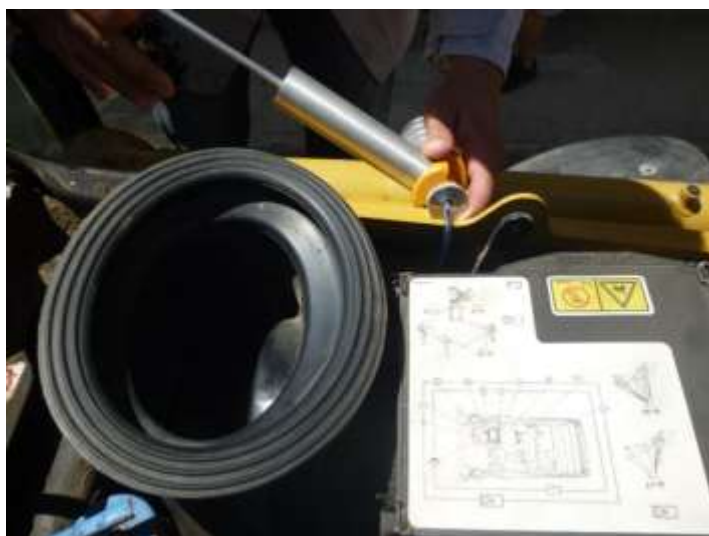
Figura 5. Extrayendo el aceite lubricante.
