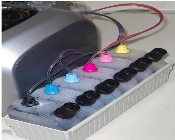
Actualmente el sistema BULK. es un adaptador para trabajar con tinta por litro que permite reducir significativamente los costos operativos por m<sup>2</sup>. Su sistema de filtros y bombas para alimentar a los cartuchos evita que los pigmentos sedimentados vayan al cabezal. Los cartuchos cuentan con un sensor de nivel de tinta para alimentar al equipo de manera constante y pareja.
