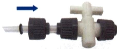
(Foto 3) Coloca y empuja la tubería de tinta en la entrada del cartucho hasta el final.
