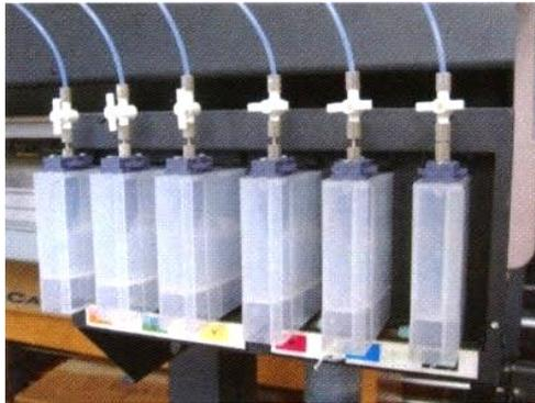
En esta parte la válvula de armario está en una posición horizontal, esto quiere decir apagado. Medio vertical encendido. Asegurarnos para poner la válvula en la posición horizontal antes de que las tintas se llenen.
