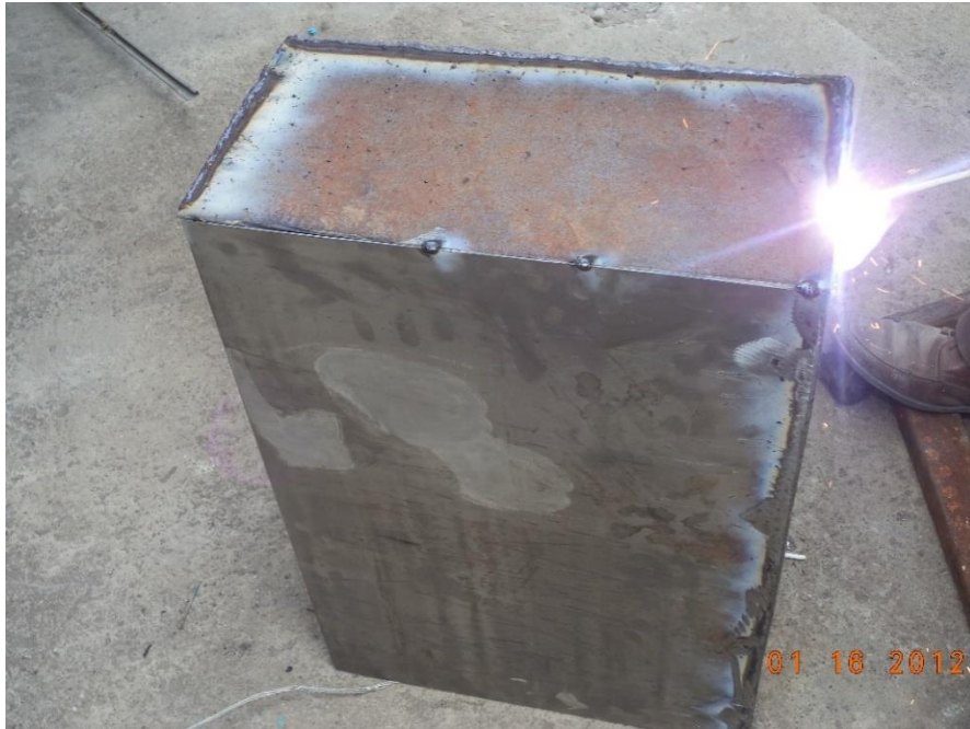
Elaboración depósito hidráulico
