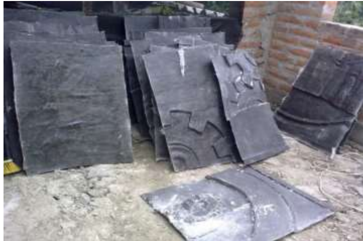
Fotografía N°- 14: Desmolde de las piezas de fibra de vidrio Fuente: Investigadores
