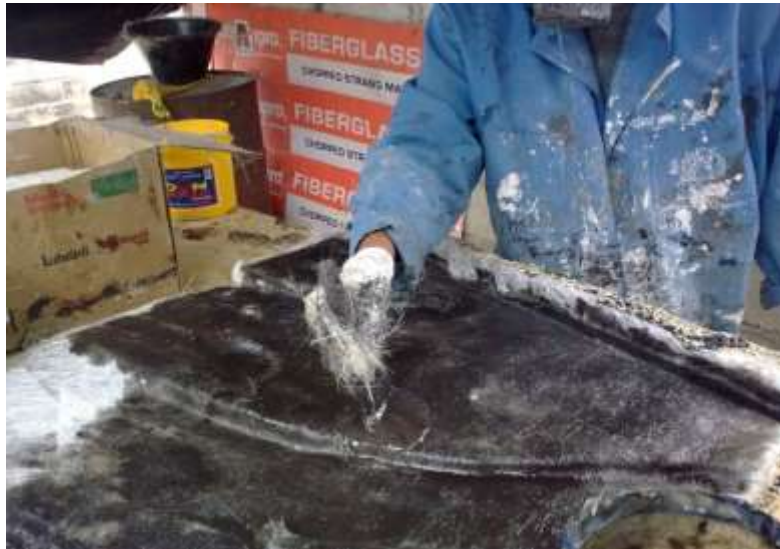
Fotografía N°- 13: Fundición con fibra de vidrio Fuente: Investigadores
